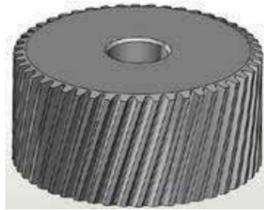
ギアの材質には特殊熱処理を施した合金鋼製を使用。さらに高精度を得るために歯車研削加工を行っており、耐摩耗性および耐衝撃性も高めている。
